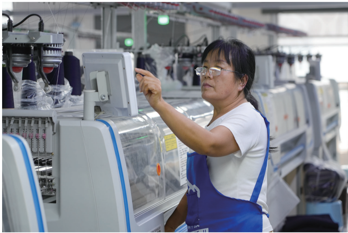
在河南西平一家服装企业智能化生产车间内,一台智能织机高速运转,一件件针织服装陆续下线。与传统生产方式不同,这里的部分产品实现“一线成衣”,从纱线到成品一次成型。图为工人在操作电脑缝纫机。
